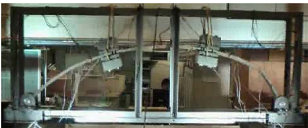
図4: 3D震動台によるRCアーチの破壊実験
