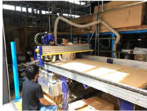
CNCによるパネルの自動加工による曲面作成
