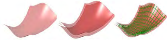
リアルタイムでの形状の確認と鉄筋レイヤーの確認
